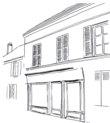
Les volets des rez-de-chaussée sont souvent partiellement persiennés, à l'étage ils le sont totalement
