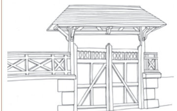
Portail en bois protégé par un auvent charpenté
