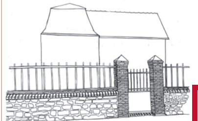
Portillon en fer d'un mur de clôture construit en moellon et brique
