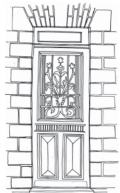
Porte en bois avec partie vitrée protégée par une ferronnerie. Cette porte est caractéristique des maisons 19 ème
