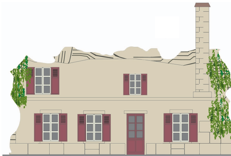
Roche et pierres de taille s'entremêlent pour former les murs des habitations
