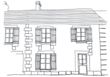
Des chaînages en pierre de taille structurent les murs de la maison de ferme
