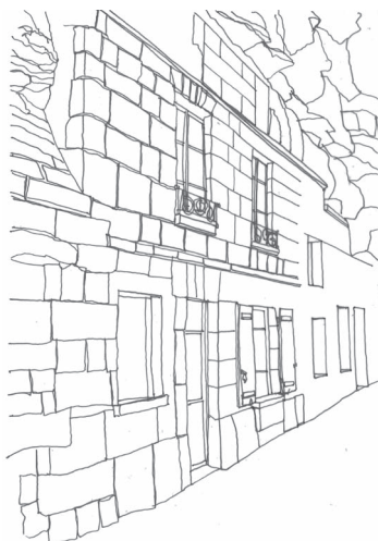
Roche et pierres de taille s'entremêlent pour former les murs des habitations
