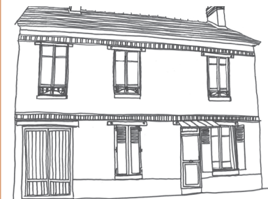
Les façades des maisons 19 ème bénéficient des matériaux de l'ère industrielle comme la brique pour les bandeaux et le métal pour les linteaux
