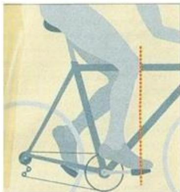
Placer la selle en position horizontale, en jouant sur le réglage du chariot. A l'œil, le réglage est impossible, surtout avec un cadre « sloping ». Assis, le bassin ne doit pas glisser vers l'avant. Une légère inclinaison (2mm) vers le bas est recommandée pour les dames. Le bassin ne doit pas avoir tendance à glisser vers l'avant.
