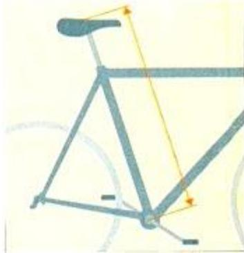
Elle se mesure de l'axe de pédalier au centre du creux de selle. Une recette simple : la hauteur de la selle se règle de telle façon que lorsque la pédale est au point le plus bas de sa course, le cycliste, en posant le talon sur cette pédale doit avoir la jambe complètement tendue. Effectuez un contrôle en pédalant en arrière avec cette fois les deux talons sur les pédales, un léger déhanchement doit être alors perçu. S'il est trop important, baissez légèrement la selle et contrôlez à nouveau.
