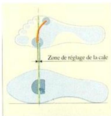
Commencer par localiser l'articulation du gros orteil. Marquer son emplacement sur la chaussure. La cale sous la chaussure doit alors être réglée (avance, recul) de façon à ce que cette marque se situe au-dessus de l'axe de la pédale. On agit sur la cale située sous la chaussure. Le bon réglage consiste à placer l'axe de l'articulation du gros orteil (bosse sur le bord interne du pied) à l'aplomb de l'axe de la pédale lorsque le pied est horizontal.
